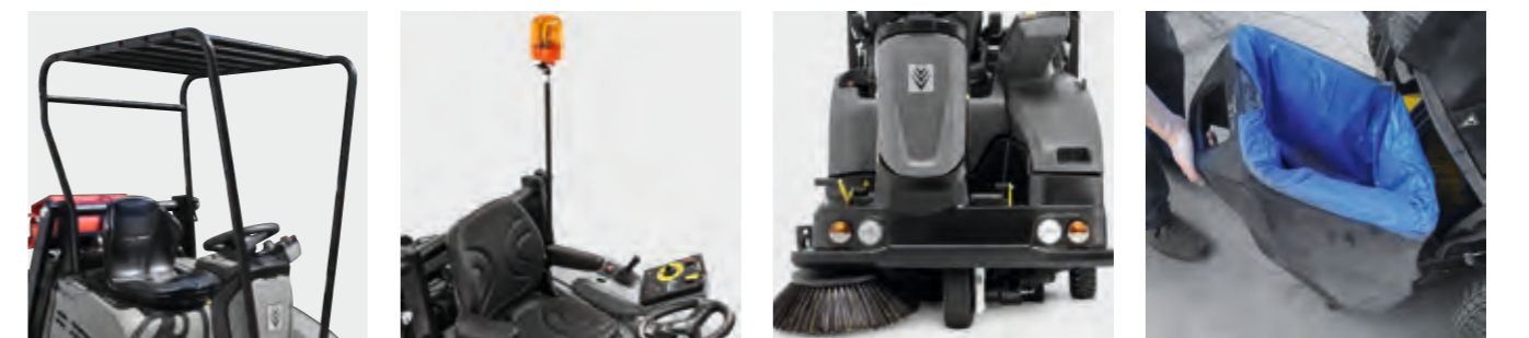
Fahrerschutzdach Fahrerschutzdach vorgeschrieben im Bereich von Hochregallagern. Für zuverlässigen und massiven Schutz.
